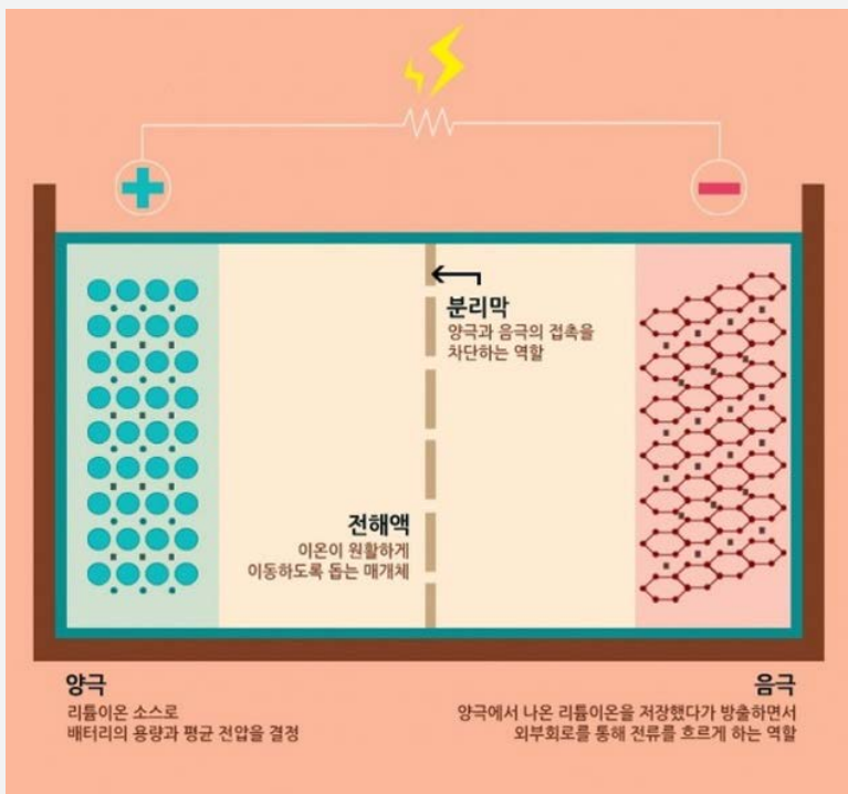
리튬이온 배터리의 4대 요소인 양극, 음극, 전해액, 분리막. (사진=삼성SDI)
