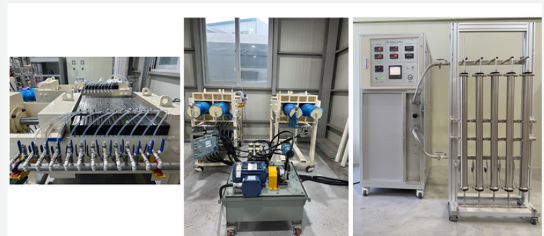
<한국화학연구원 박유인 화학공정연구본부 LCP융합연구단 책임연구원팀이 개발한 의약품 유기용매 나노 분리막 실증 모듈과 시스템>
